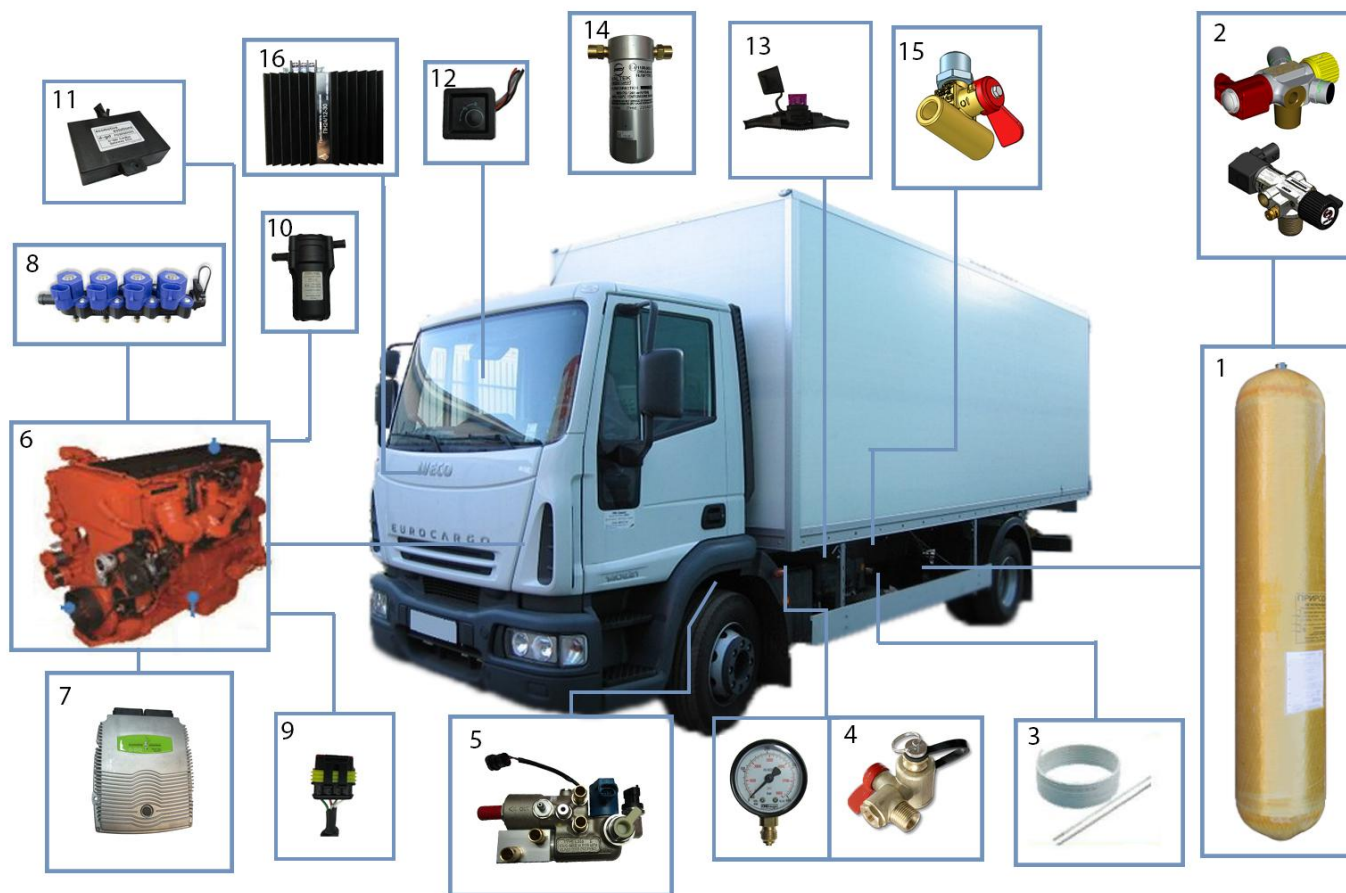
РИС. 11 2- кассета с баллонами расположена с левой стороны за аккумуляторным ящиком; 2- запорные вентили; 3- магистраль высокого давления проходит по раме с внешней стороны от баллонов до редуктора; 4- выносное заправочное устройство располагается на аккумуляторном ящике; 5- редуктор располагается на раме в моторном отсеке; 6- двигатель а/м; 7- блок ЭБУ газодизельной системы; 8- рампа газовых форсунок установлена на блок цилиндров ДВС; 9- разъемы bypass устанавливаются для восстановления штатной проводки, при выходе блока ЭБУ ГТС из строя; 10- фильтр низкого давления установлен между редуктором и газовой рампой; 11- преобразователь напряжения установлен на усилители торпедо с пассажирской стороны; 12- кнопка включения/отключения «газодизельного» режима; 13- предохранители установлены в аккумуляторном ящике; 14- фильтр высокого давления установлен перед аккумуляторным ящиком на раме; 15- магистральный кран установлен перед аккумуляторным ящиком.
